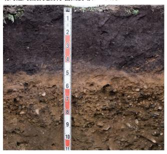
中札内台地の礫層の上に樽前山の火山灰が堆積してできた土です。厚さ40cmの真っ黒な作土、褐色の粘土質な下層土、そして60cm 以深は礫層へと続いています。この礫層は角のとれた円い石ころのため、かつて台地を流れる川によって運ばれてきたのでしょう。 保水性・排水性ともに良好で、かつ耕盤層は形成されていないため、ビートの根が礫層まで達しています。 有機物(鶏ふんなど)を施用し、下層の石礫を表土に持ち上げることなく、絶妙な塩梅でプラウ耕が入り、"職人技"を感じとれる土壌断面です。
