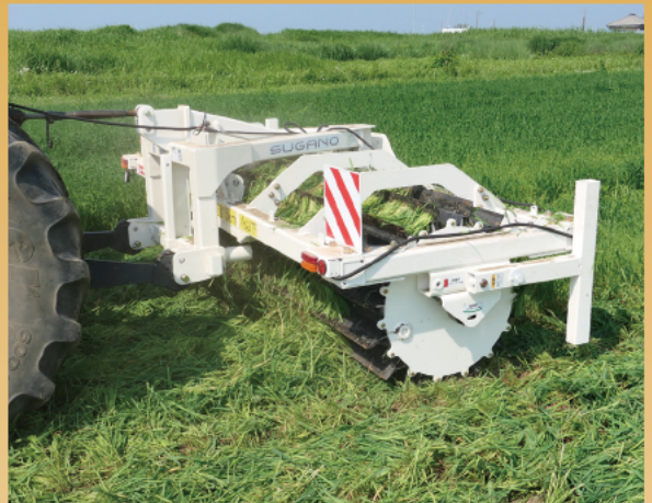
緑肥の切断作業(フロント3点装着)
