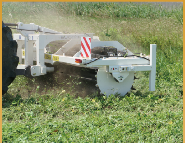
耕作放棄地での刈払い作業(フロント3点装着)
