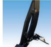
土を上げずに硬盤の破碎ができるサブソイラになります。上下対称のくの字型はナイフの局部摩擦を減少させ破碎力も大きく、また、土の盛り上がりが少ないので後作業に支障を与えません。
