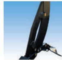
土を上げずに硬盤の破碎ができるサブソイラになります。上下対称のくの字型はナイフの局部摩擦を減少させ破砕力も大きく、また、土の盛り上がりが少ないので後作業に支障を与えません。
