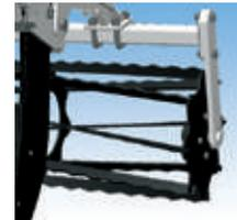
プラソイラの作業と同時に砕土・鎖圧が行え、ロータリなどの後作業を容易にします。
